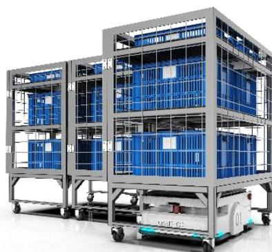
Oasisシリーズはの物流や工業製造現場での材料の輸送用に設計されています。制御ソフト(FMS)と合わせて、E2Eのソリューションを提供できます。ロボットは、AMRの信頼性と高精度なセンサーおよびコンベアなどを組み合わせ、人間の意思が反映できる柔軟性のある人工知能を持つロボットである。Oasisは、床にマーク、テープ、レーザーパスなどを一切必要なく、既存の環境を変えることなく導入できるAMR。環境に柔軟に適応し、高速マッピングし自動化したシステムを提供します。平均時速7km/hで24時間365日稼働できます。生産ラインや目的に合わせて追加装置を装着をし、さまざまなタスクをこなすことが可能。
