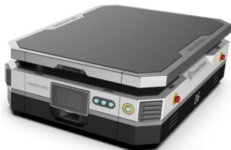
AMR-600-CEデュアルレーダー搬送ロボットは、前後2つのレーダーとレーザーSLAMナビゲーション技術を採用し、360°の検出を実現しています。環境の自動マッピング、自律的な経路計画、安全な障害物回避、自動充電などの機能を備えています。
